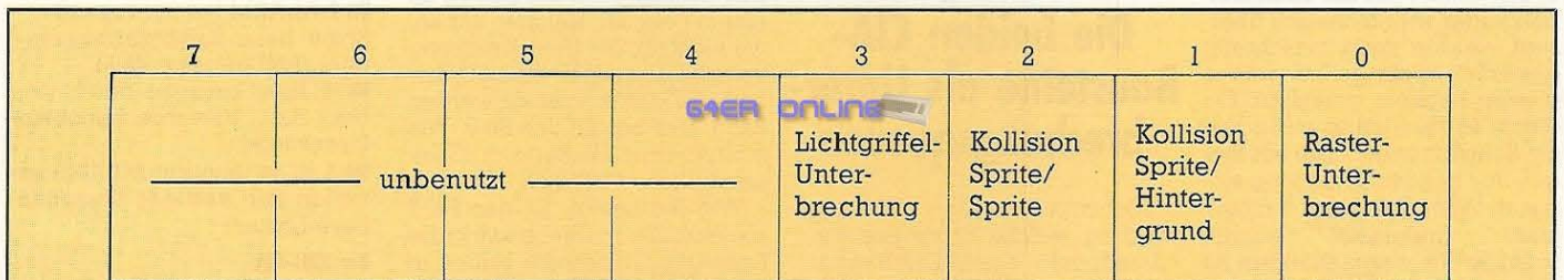
Bild 3. Das Interrupt-Enable-Register (53274 = $d01a) des VIC-II-Chip
